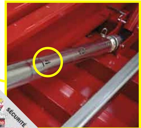
Verrouillage du tube mâle dans le tube femelle par broche imperdable
