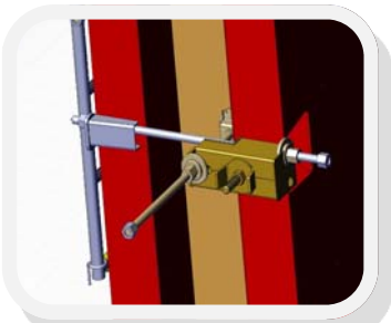
Montage avec griffe : obligatoire pour coulage BAP de 15 à 25.
