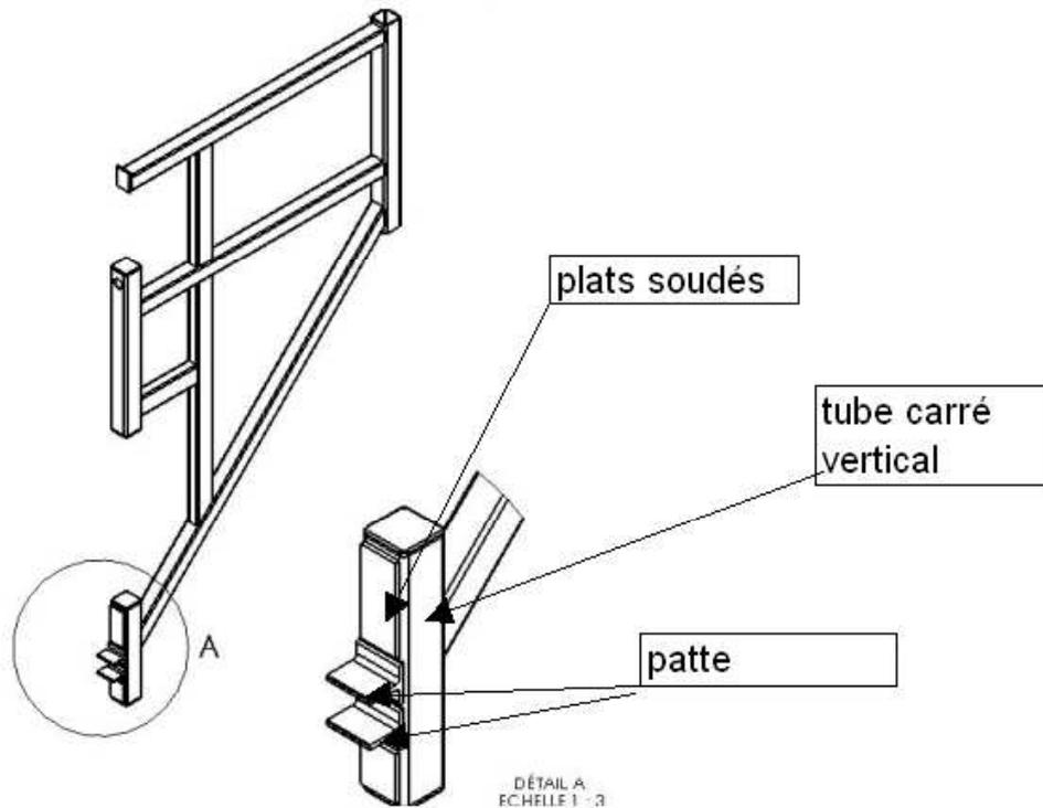
\* Les deux pattes qui équipent les consoles peuvent être supprimées par tronçonnage au droit des plats soudés sur le tube carré vertical.
